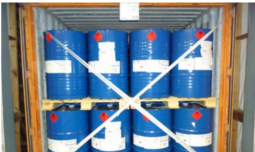
L'intérieur d'un conteneur équipé d'un appareil de surveillance (au centre, en haut). La partie du capteur qui dépasse du conteneur n'est pas visible sur cette photo.
